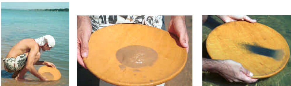
Fig. 1.10. Concentração de minerais pesados por meio de uma batéia mecânica.
