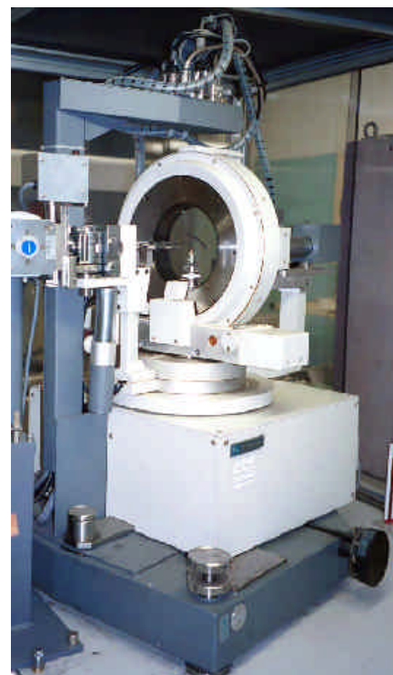
Fig. 1.4. Difrátômetro Raios-x de quatro eixos para análises monocristais da Universidade de Hirosaki, Japão.
