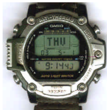
Fig. 1.19. Relógio de pulso que aproveita piezoelectricidade de quartzo.
